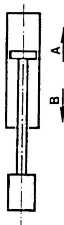
Hydraulikzylinder ohne Ausgleichventil
